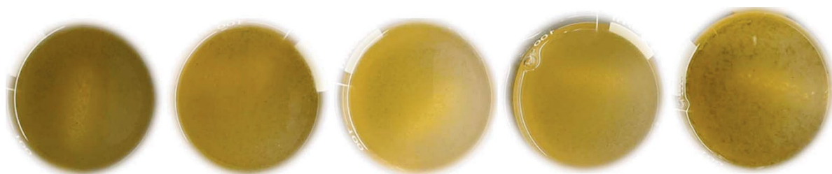
Рис. 3. Формирование хлопьев активного ила после дозирования коагулянта
