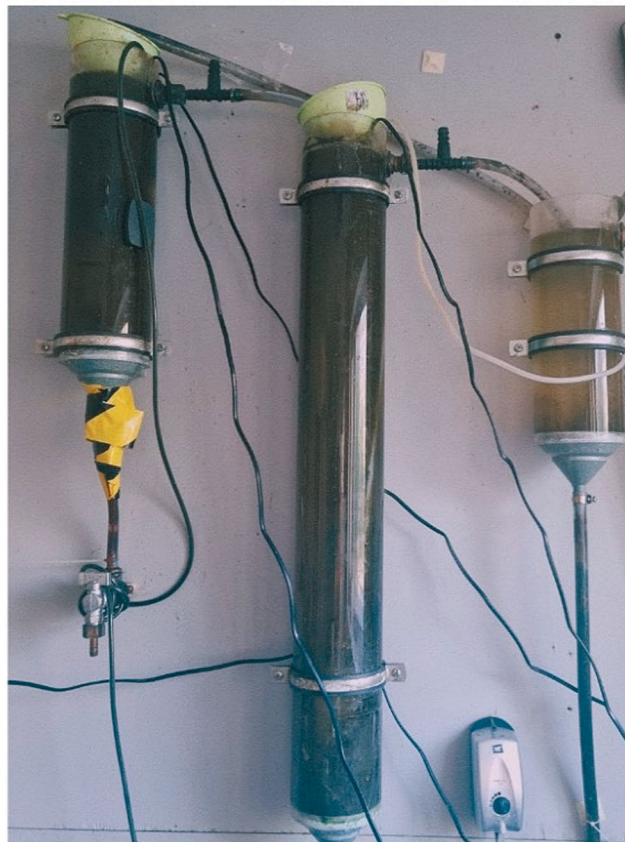
Рис. 2. Модель экспериментальной лабораторной установки биореактора. Точки отбора проб отмечены красным цветом: 1 — насос-дозатор для подачи сточной воды; 2 — компрессоры аэрации
