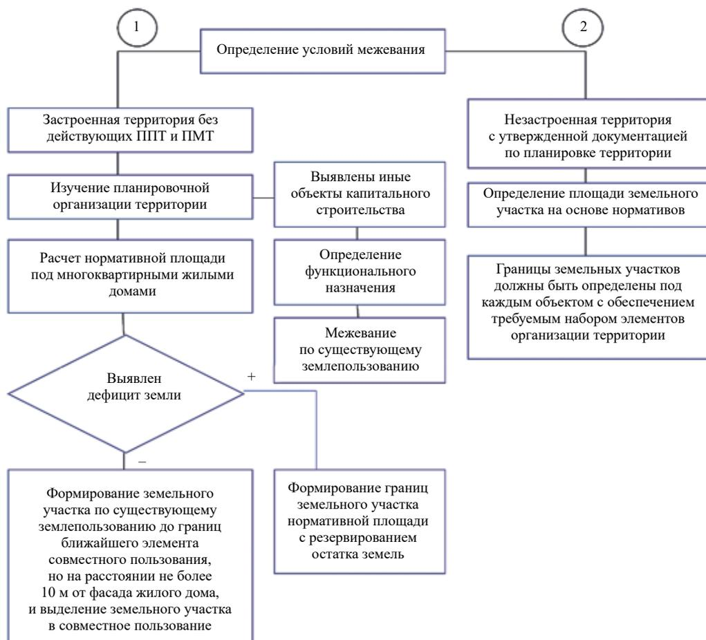
Рис. 2. Блок-схема оптимизации проектной работы по межеванию
