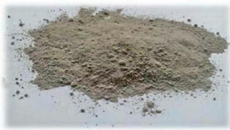
Рис. 2. Продукт очистки отходящих дымовых газов предприятия «Рагос»
