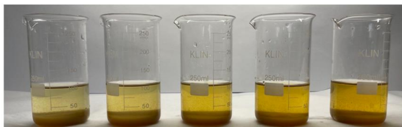
Рис. 7. Осаждение после коагулирования
