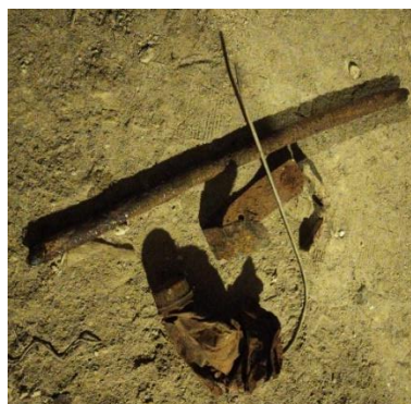
Рис. 5. Посторонние предметы, извлеченные из стояка перед монтажом рукава
