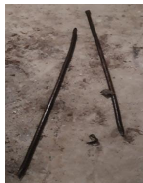
Рис. 5. Посторонние предметы, извлеченные из стояка перед монтажом рукава
