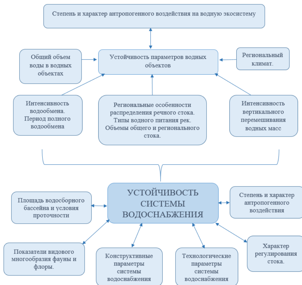
Рис. 3. Схема оценки устойчивости систем водоснабжения
